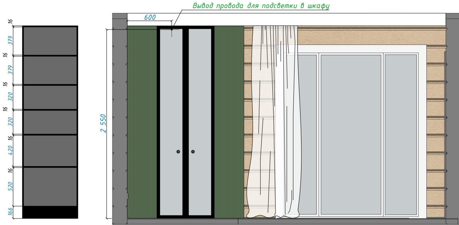
Схема развертки стен
